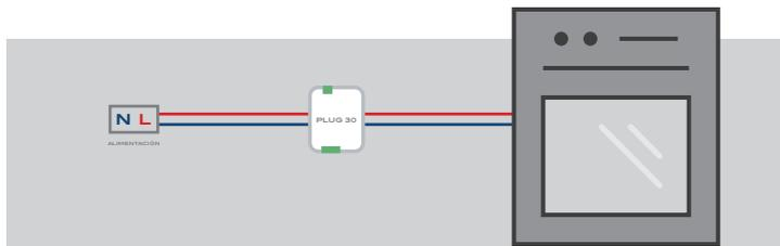
Se instala el dispositivo domótico **Plug 30** en la línea de alimentación del horno y/o vitrocerámica.
